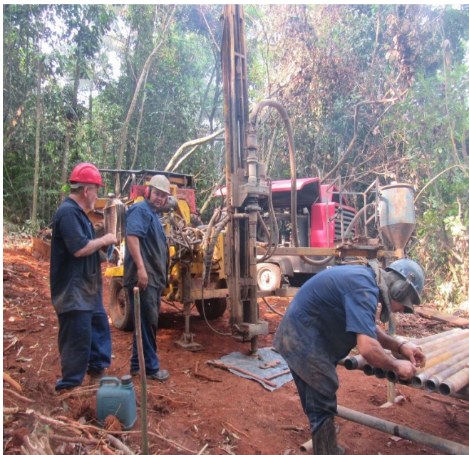
RC drilling on Tres Estados
